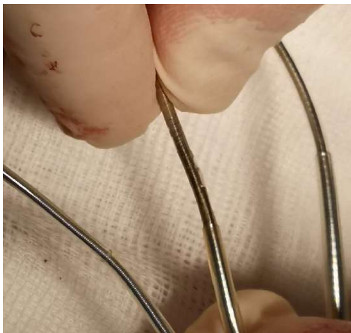
Рисунок 15 – Нарушение изоляции желудочкового электрода
